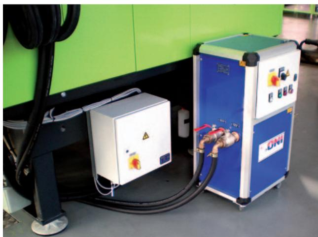
*Auch ein „dauer temperieren“ definierter Kreisläufe ist mit der eingebundenen Vorwärmeinheit möglich*
