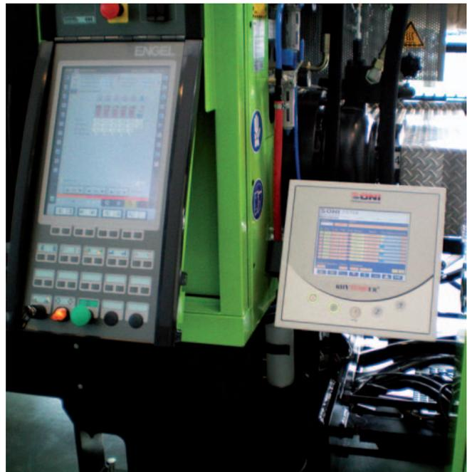
*Die neue Bedieneinheit des Rhytemper ermöglicht eine einfache und selbsterklärende Bedienung*
