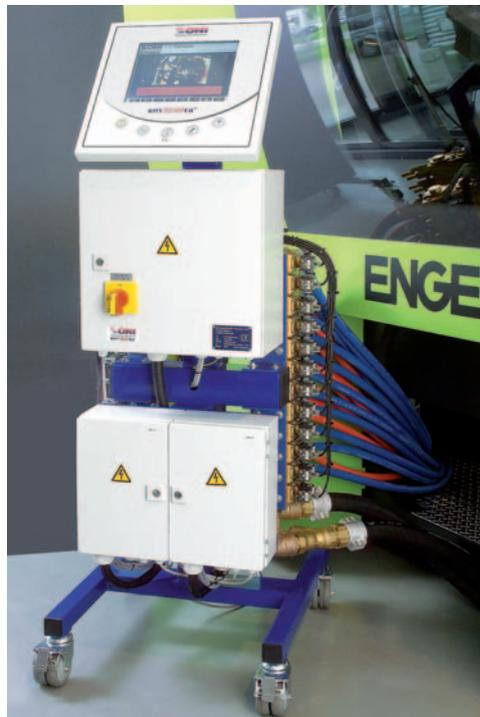
*Beim Impulstemperier-System Rhytemper FlexControl wird das Wärmeniveau ständig kontrolliert und der Kühlimpuls wenn nötig automatisch angepasst*
