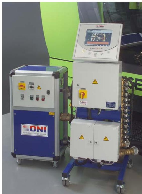
Das System „Rhytemper HotPulse“ stellt heißes Wasser zum Pulsen zur Verfügung. Werkzeugwandtemperaturen oberhalb 150°C sind möglich
